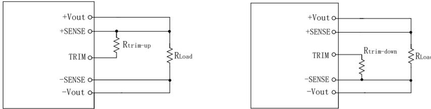
外加电阻分别于 TRIM 端与 Vo 之间,可使输出电压在 90%—110%Vout 范围内增大或减小。电阻加在 TRIM 端与 Vo+之间,输出电压增大;电阻加在 TRIM 端与 Vo-端之间,输出电压减小。调整过程中,调整电阻尽可能的靠近模块电源的引针。不需要此功能时,TRIM 端悬空。
